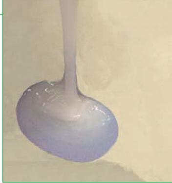
Трехкомпонентный гидрофильный гель для консолидации грунтов, гидроизоляции оснований и заградительных инъекций в бетон.
