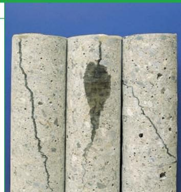
**Двухкомпонентная супертекучая эпоксидная смола для инъекций.**
