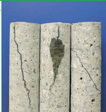
**Двухкомпонентная супертекучая эпоксидная смола для инъекций.**
