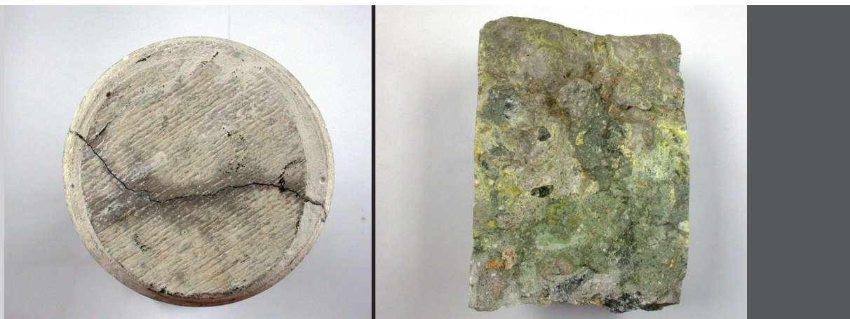
фото 12 Образец, взятый из сердцевины бетона, разрушенной структуры
