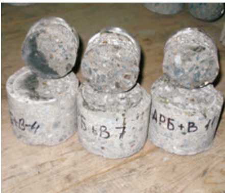
Рисунок П7 Испытания на адгезию, происходит когезионное разрушение бетонной подложки
